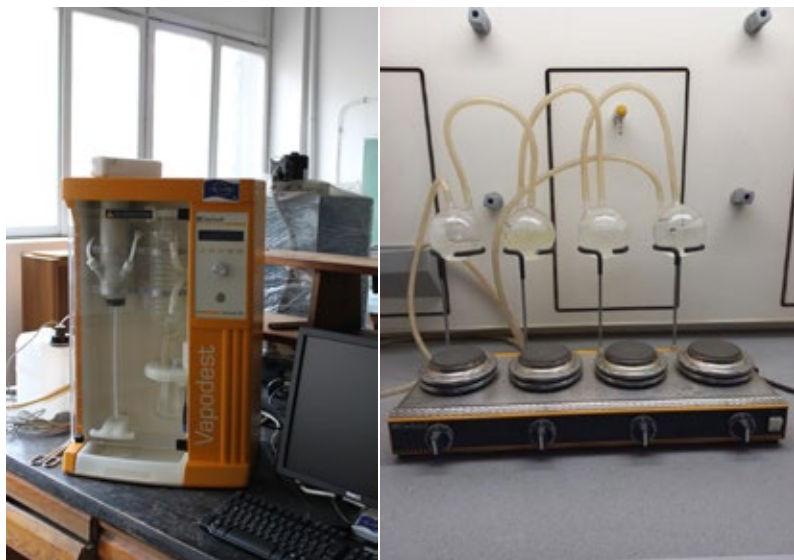
Kjeldahl – për përcaktimin e azotit dhe proteinave dhe Soxterm - për hidrolizën
