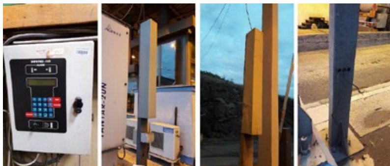
Pajisjet për zbulimin e hyrjes dhe kalimit të paligjshëm të materialeve radioaktive.
